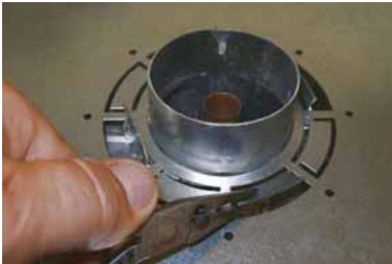
Рис. 6.2.3.2. Способ отгибания ограничителей потока воздуха (крылышек) – вид сверху газового аппарата
